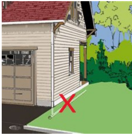
Branchement au drain de fondation, dans la plupart des cas, le drain est connecté au
