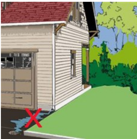
Déversement par l'entrée asphaltée où l'eau coule vers le réseau d'égout.
