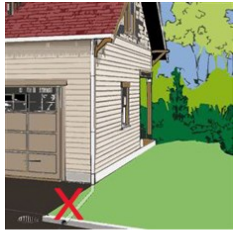
Branchement direct à la rue où l'eau coule vers le réseau d'égout.
